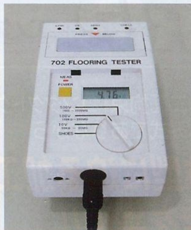
静電気対策工事 (導電性フロアシート工事) 後に導電性の確認を実施
